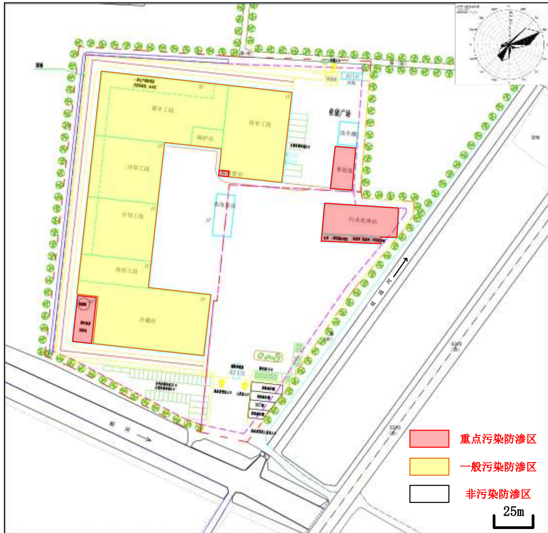
图 6-3 项目厂区分区防渗图
