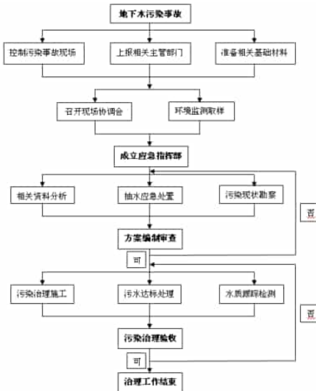
图 5.6-42 地下水污染应急治理程序框图
