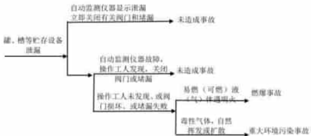
图 6.2-4 储运系统事件树示意图
