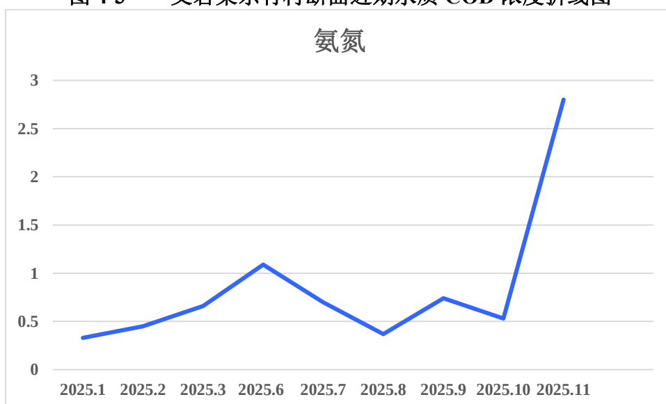
图 4-4 文岩渠东竹村断面近期水质 NH 3 -N 浓度折线图
